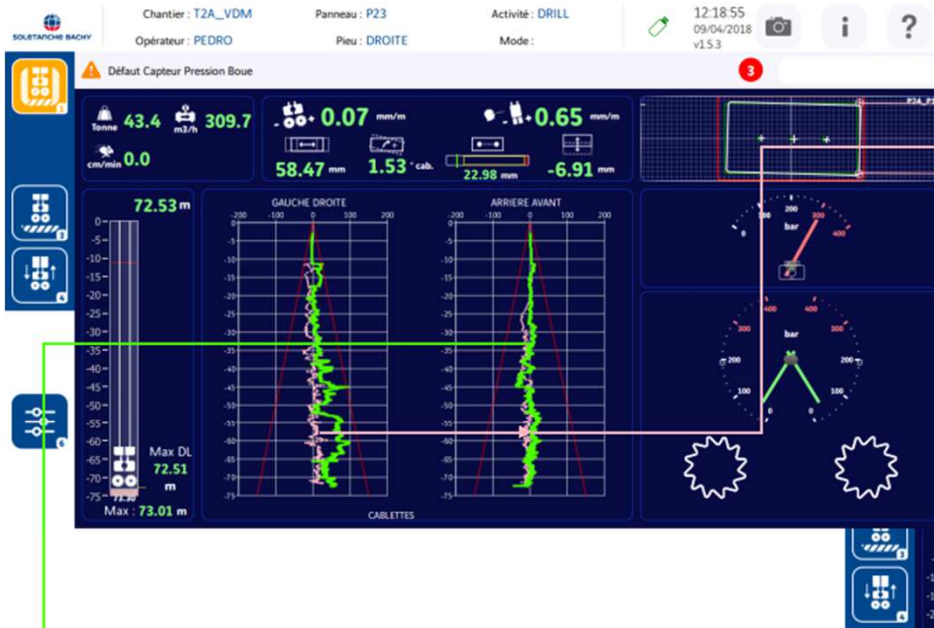
Déviations du pieu en cours de perforation
